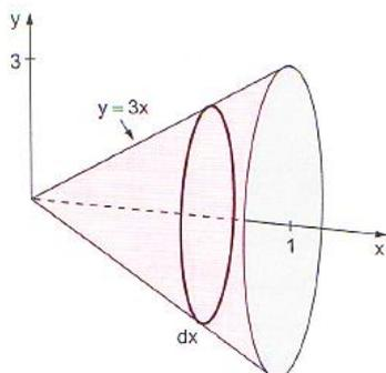
Das Integral  $\int_a^b A(x) dx$  kann als unendliche Summe von Produkten interpretiert werden. Dabei werden die Faktoren  $A(x)$  als   1   und  $dx$  als   2   „kleiner Körper“ geometrisch gedeutet.
